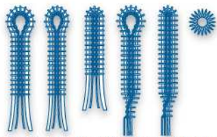
Typische Knopfloch- und Riegelformen Typical eyelet and tack types
